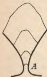
Abb. 86. Auftrieb ein. Lichtbogens an Hörnern.
